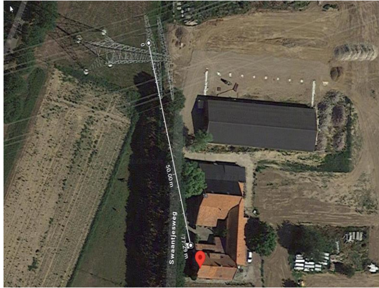
Figuur 2-2 Schematische situatie rondom de locatie in Echt t.o.v de 150 kV lijn. Opmerking, de afstandslijn dient in deze figuur enkel als indicatie voor de bepaling van de 0,4 microTesla contour (zie verder in het rapport) De afstand wordt geschat op 77.3 meter tot aan de woning met nummer 14, zoals in de tekening is weergegeven
